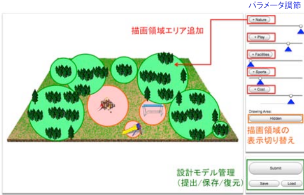
図 6: 設計モデルのベース作成システム
